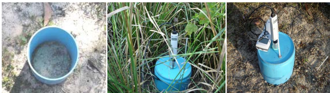
ภาพที่ 2 การติดตั้งท่อพีวีซีในแปลงทดลองและวัดปริมาณการปลดปล่อยก๊าซคาร์บอนไดออกไซด์
